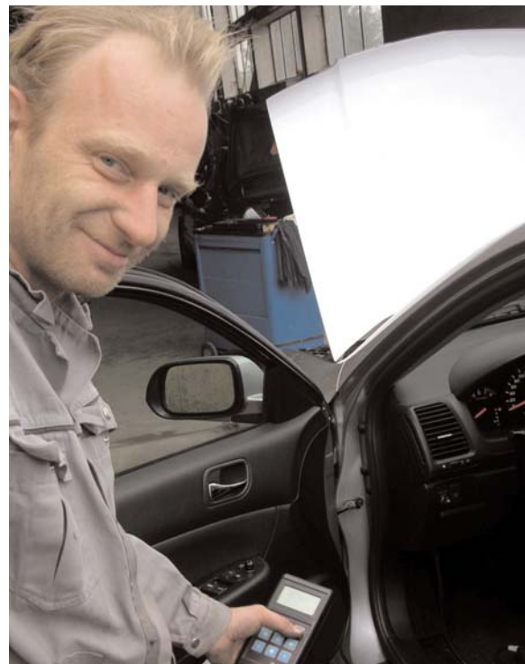
2500 Kilometer später: Guido Matthes liest über das serienmäßige „On-Board-Diagnose“-System die Motordaten aus – tadelloser Lauf
